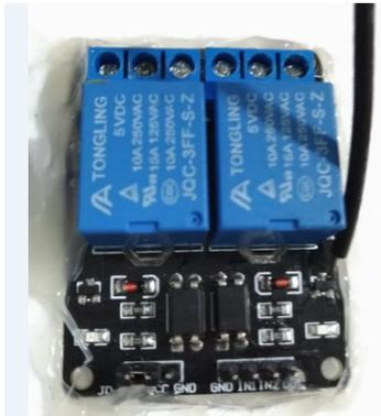
Figure 2: Módulo com dois relés.
